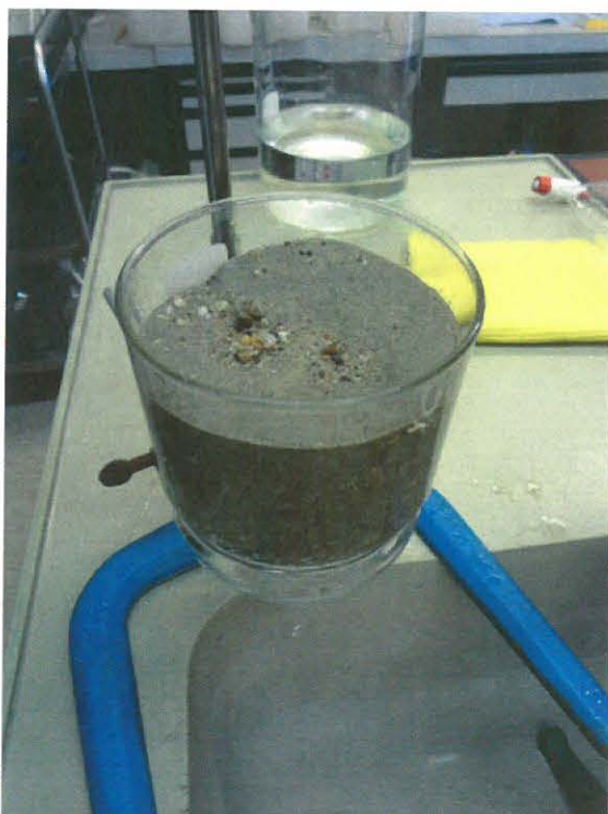
Filtermedium "Sand" nach der 2. Versuchsanordnung "Weiterlaufen der Grundwasserpumpe"
