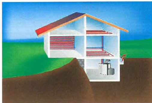
Abbildung 12: Schema einer Luft-Wärmepumpe
