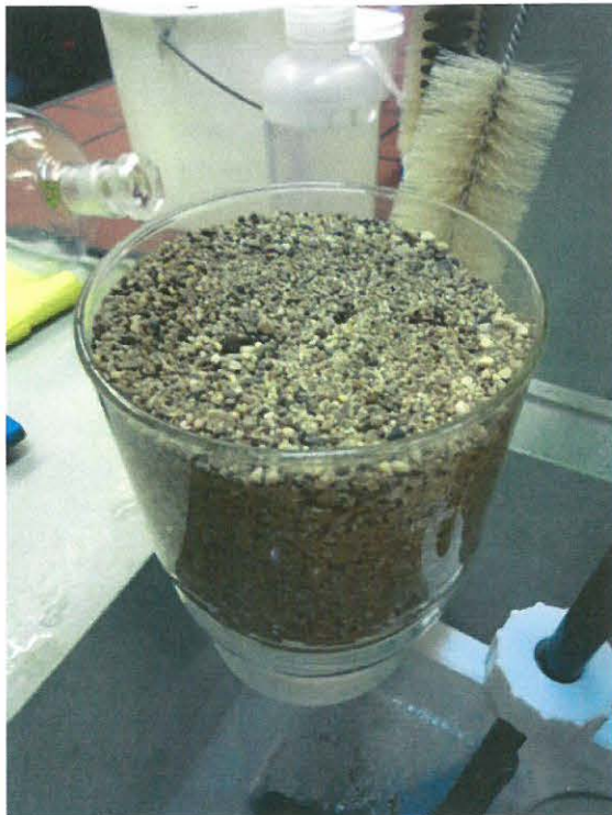
Filtermedium "Unterkorn" nach der 2. Versuchsanordnung "Weiterlaufen der Grundwasserpumpe"
